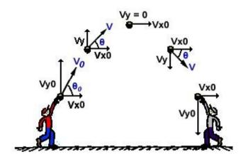
Como la velocidad inicial forma un ángulo  $\theta$  con la horizontal, entonces tiene dos componentes  $v_{0x}$  y  $v_{0y}$ , dadas por:
