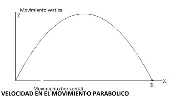
El movimiento vertical ascendente del cuerpo disminuye su velocidad exactamente en la misma proporción en la que aumenta cuando se dirige hacia abajo. El cuerpo asciende y pierde velocidad hasta que se detiene, instantáneamente, en el punto más alto, y luego desciende empleando en regresar al mismo nivel el mismo tiempo que empleó en subir.
